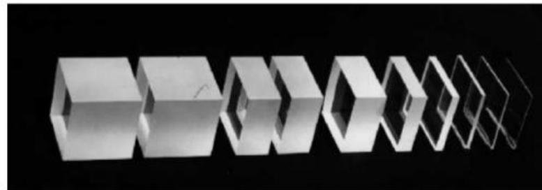
Blocs de spath d'un filtre de LYOT
